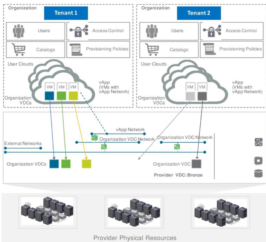
Платформа віртуалізації створює програмно-визначені провайдерські VDC, ресурси яких використовує вищий Сервісний шар.
